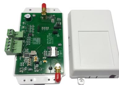
Зона уверенного приема сигнала радиобрелока (прямая видимость) с внешней антенной - до 30 м (зависит от типа антенны и радиочастотной обстановки).
