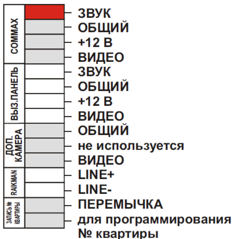
Рис.2 Цоколевка соединительного шлейфа.
