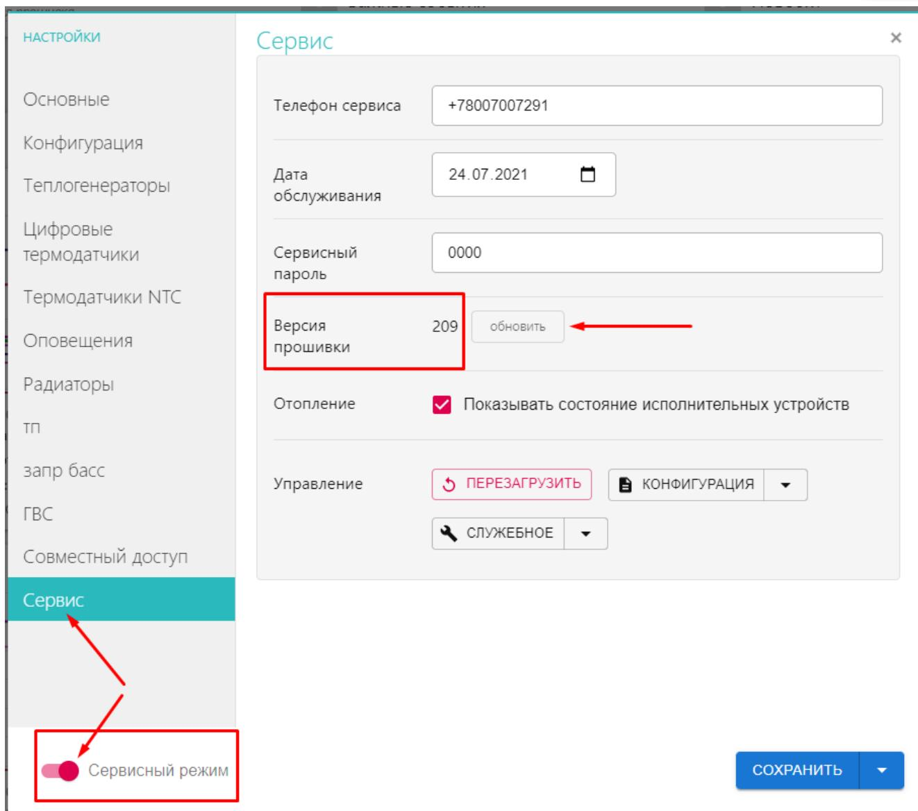
**ВНИМАНИЕ!!!** Во время обновления версии прошивки ни в коем случае нельзя отключать Регулятор от сети. В случае перебоев в питании и при не полностью заряженном внутреннем аккумуляторе может произойти сбой, что приведет к полной неработоспособности Регулятора. Восстановление работоспособности в этом случае возможно только в заводских условиях.
