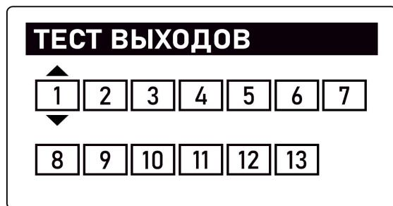
Кнопками и осуществляется выбор реле, а кнопками / и – включение и выключение. Включенное реле подсвечивается инверсией.
