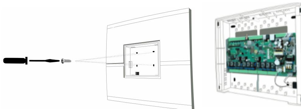
9. Установите панель управления Регулятора в основной корпус устройства.
