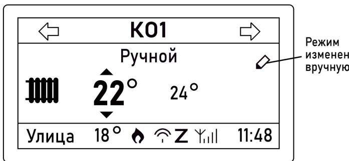
**Примечание:** Целевая температура, введенная в ручном режиме, применяется только до переключения контура в один из предустановленных (Комфорт, Эконом, Выкл) режимов.
