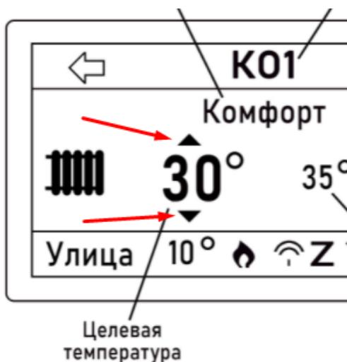
**Примечание:** В режиме “Выключен” запрос тепла к теплогенераторам не формируется (отключается нагрев теплоносителя), но при этом работает автоматическая функция **защиты насосов от заклинивания**, которая включает прокрутку насосов каждые 24-е часа на 60
