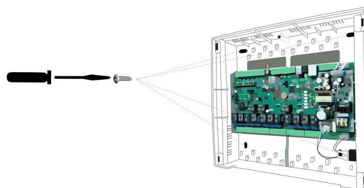
4. Установите SIM-карту в слот держателя до щелчка. Контактная группа SIM-карты должна быть обращена к задней стенке корпуса Регулятора и подключите GSM-антенну:
