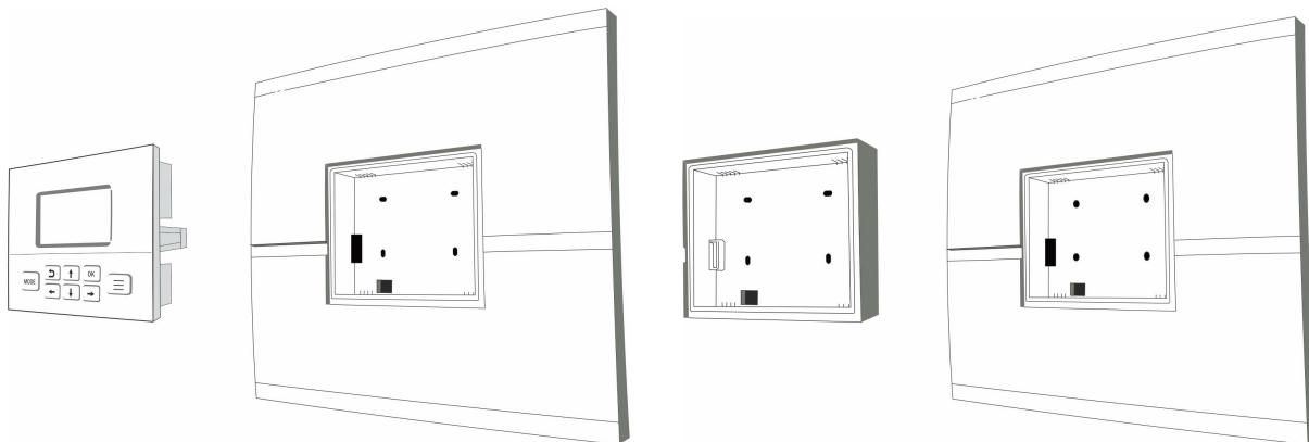
2. Отожмите 4-е защелки лицевой панели прибора и снимите ее с корпуса Регулятора, открыв доступ к электронной плате:
