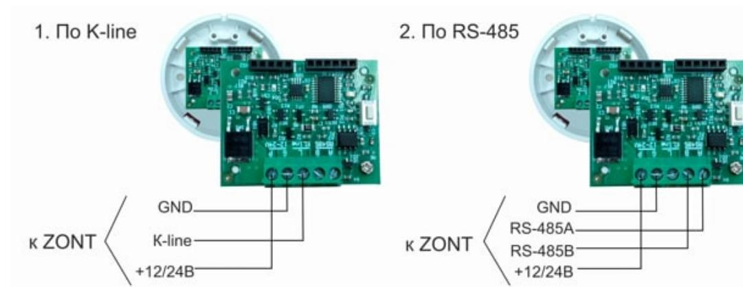
Максимальная длина линии RS-485 не более 200 м. При большем удалении датчика от Регулятора рекомендуется устанавливать дополнительные резисторы 120 Ом между клеммами А и В с обоих концов линии и использовать кабель UTP (витую пару) CAT5.
