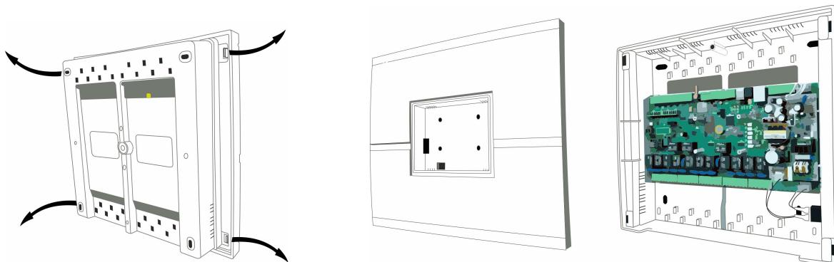
3. Закрепите Регулятор в месте его применения, использовав винты крепления и монтажные отверстия корпуса:
