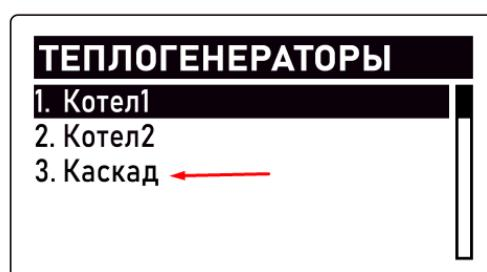
Алгоритм работы каскада котлов основан на контроле температуры теплоносителя по **датчику гидрострелки**. Это отдельный датчик из комплекта поставки Регулятора, подключаемый ко входу “Теплоноситель”.
