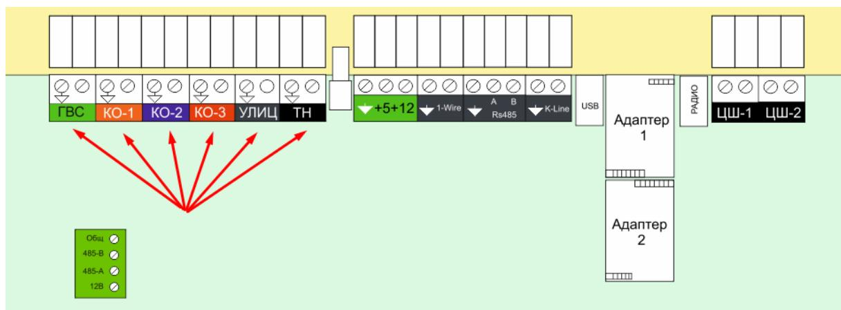
6. Если реализуемой конфигурацией системы отопления предусмотрено управление котлом (котлами) по цифровому интерфейсу, установите плату (платы) цифровой шины (в комплект поставки не входят, приобретаются отдельно), в соответствующие гнезда платы Регулятора.
