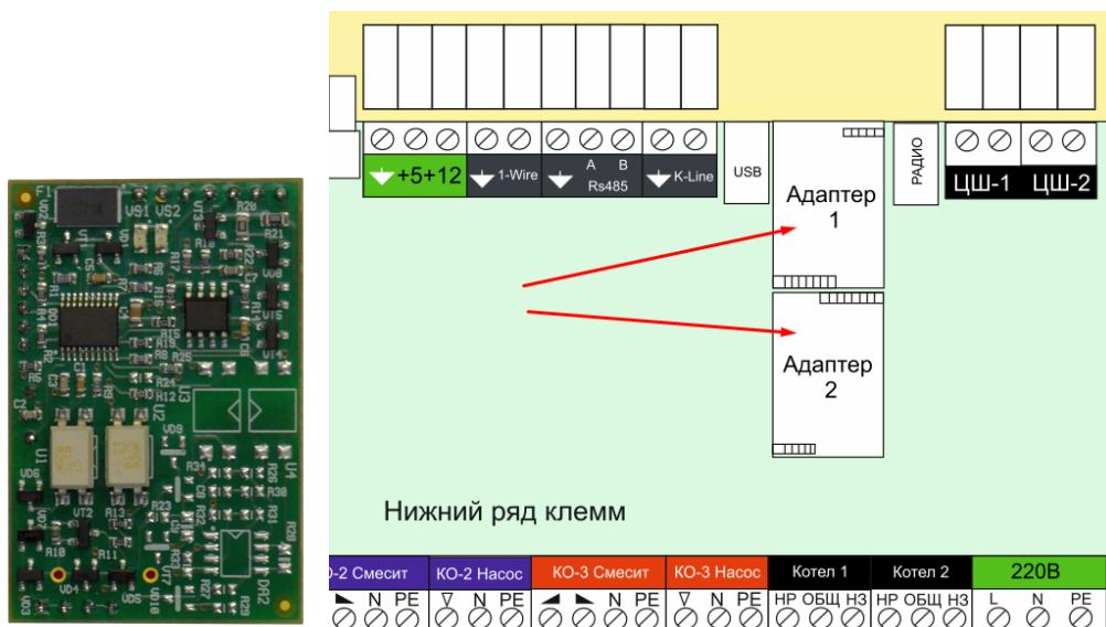
Данные платы реализуют возможность обмена данными и управления работой котла по поддерживаемому им цифровому интерфейсу и разделяются на:
