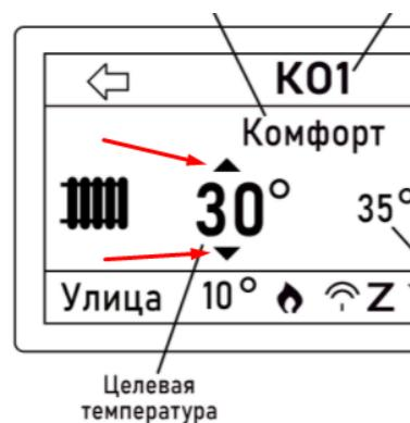
воздуха в помещении в соответствии с задаваемом в контуре целевым значением температуры воздуха. При изменении температуры на улице в помещении должна сохраняться постоянная температура. Номер кривой ПЗА зависит от теплопотерь здания.
