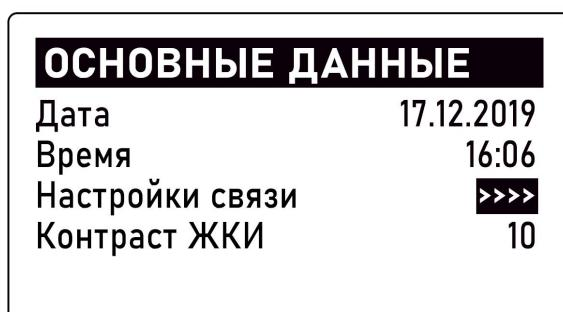
“Дата” и “Время” – отображают информацию о текущей дате и времени, синхронизированной с данными интернета.. Отдельная настройка требуется только при эксплуатации Регулятора автономно, без связи с сервером.
