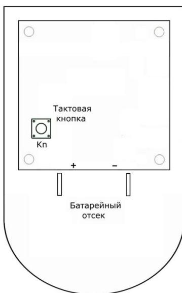
Радиокнопка вызова устанавливается с использованием накладного монтажа. Для подключения радиокнопки закрепите на стене держатель с помощью 2-х саморезов и дюбелей через намеченные в нем 2 отверстия. Затем отсоедините верхнюю крышку радиокнопки, открутив 4 самореза. Далее необходимо запрограммировать кодовую посылку.
