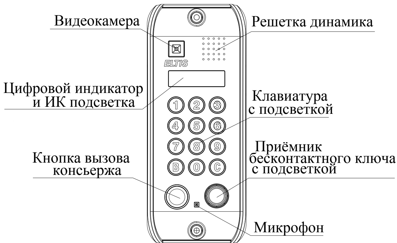
Рис.2 Внешний вид со стороны лицевой панели
