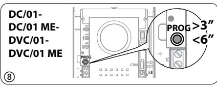
**Программирование угла обзора камеры вызывной панели.** При программировании кнопок вызова настройка угла обзора камеры может быть выполнена в соответствии с описанной выше процедурой.
