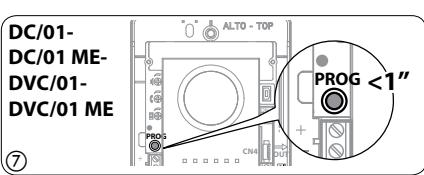
**Выход из режима перепрограммирования.** Кратковременно нажмите на кнопку PROG ⑦: светодиод PROG выключится. ПРИМЕЧАНИЕ. Если действие не выполнено, выход из режима будет произведен автоматически через 30 минут.
