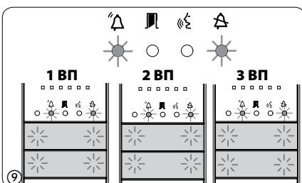
**Выход из режима перепрограммирования.** Кратковременно нажмите на кнопку PROG на контроллере ⑦: светодиод PROG выключается. ПРИМЕЧАНИЕ. Если действие не выполнено, выход из режима будет произведен автоматически через 30 минут.
