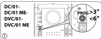
**Вход в режим программирования.** Удерживайте кнопку PROG ① не менее 3 секунд, затем отпустите ее (не позднее 6 секунд), в результате загорится светодиод PROG. Если светодиод PROG внезапно гаснет или не загорается - это означает неисправность соединения. Проверьте соединения и повторно войдите в режим программирования. Светодиоды вызывной панели включаются, как показано на рис. ②. Подождите 5 секунд для завершения самотестирования, затем продолжите, как описано ниже.
