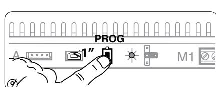
**Изменение уровня яркости изображения с вызывной панели.** При программировании кнопок вызова уровень яркости изображения с вызывной панели может быть изменен с помощью программируемого абонентского устройства (с поднятой трубкой, если таковая есть).
