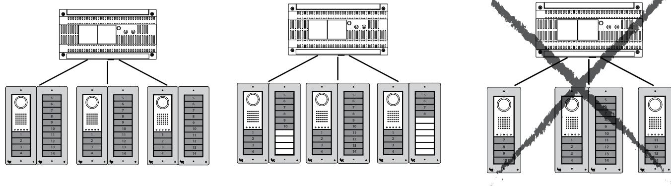
Вызывные панели (подключенные к одному и тому же контроллеру) можно запрограммировать с различными типами кнопок, в соответствии с последовательностью, показанной снизу.
