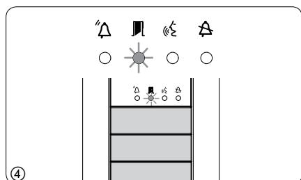
**Программирование типа кнопок и адресов.** Нажмите на первую кнопку на вызывной панели ③/③A/③B, пока не перестанет мигать светодиод ② и светодиоды подсветки ④
