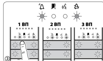
**Программирование типа кнопок и адресов.** Нажмите на первую кнопку на вызывной панели ③, пока не перестанет мигать светодиод и светодиоды подсветки. Повторите процедуру на всех вызывных панелях, которые следует запрограммировать ④ ⑤: по окончании процедуры индикация на ВП будет соответствовать рис. ⑥.
