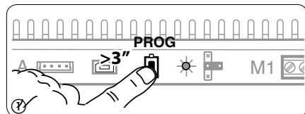
**Вход в режим программирования.** Удерживайте кнопку PROG ① на контроллере не менее 3 секунд, пока не загорится светодиод PROG. Если светодиод PROG внезапно гаснет или не загорается - это означает неисправность соединения между контроллером и вызывной панелью. Проверьте соединения и повторно войдите в режим программирования.
