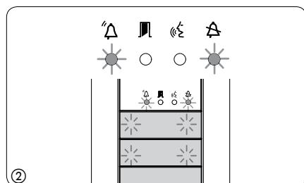
**Программирование типа кнопок и адресов.** Нажмите на первую кнопку на вызывной панели ③/③A/③B, пока не перестанет мигать светодиод ④ и светодиоды подсветки ④.
