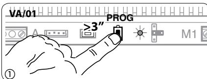
**Вход в режим программирования.** Удерживайте кнопку PROG ① на контроллере не менее 3 секунд, пока не загорится светодиод PROG. Если светодиод PROG внезапно гаснет или не загорается – это означает неисправность соединения между контроллером и вызывной панелью. Проверьте соединения и повторно войдите в режим программирования. Светодиоды вызывных панелей включаются, как показано на рис. ②. Подождите 5 секунд для завершения самотестирования, затем продолжите, как описано ниже.
