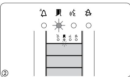
**Перепрограммирование кнопок вызова.** Поднимите трубку абонентского устройства (при наличии), которое требуется запрограммировать ③, затем одновременно нажмите на клавиши открытия дверного замка и AUX2 ♦ ④. На вызывной панели нажмите ту кнопку вызова, которой будет вызываться данное абонентское устройство ⑤: звуковой сигнал будет означать, что настройка выполнена. Положите трубку на абонентское устройство ⑥ и продолжите программирование, выполняя те же действия для других устройств.
