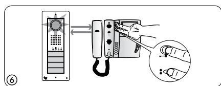
**Выход из режима программирования.** Кратковременно нажмите на кнопку PROG на вызывной панели ⑩: светодиод PROG выключится. **ПРИМЕЧАНИЕ.** Если действие не выполнено, выход из режима будет произведен автоматически через 30 минут.
