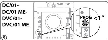
**Программирование угла обзора камеры вызывной панели.** При программировании кнопок вызова поле обзора камеры можно настроить с использованием любого абонентского устройства (с поднятой трубкой, если таковая есть), нажимая на клавишу активации вызывной панели ⑩. Начиная с конфигурации по умолчанию, можно перейти к следующей ⑪ с помощью клавиши AUX1 ● или вернуться к предыдущей конфигурации с помощью клавиши AUX2 ♦ ⑫: настройка будет автоматически сохранена.
