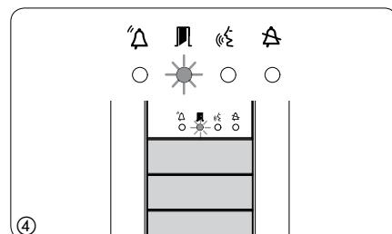
**Программирование кнопок вызова.** Поднимите трубку абонентского устройства (при наличии), которое требуется запрограммировать ⑤, затем одновременно нажмите на клавиши открытия дверного замка ▨ и AUX2 ● ⑥. На вызывной панели нажмите ту кнопку вызова, которой будет вызываться данное абонентское устройство ⑦: звуковой сигнал будет означать, что настройка выполнена. Положите трубку на абонентское устройство ⑧ и продолжите программирование, выполняя те же действия для других устройств.
