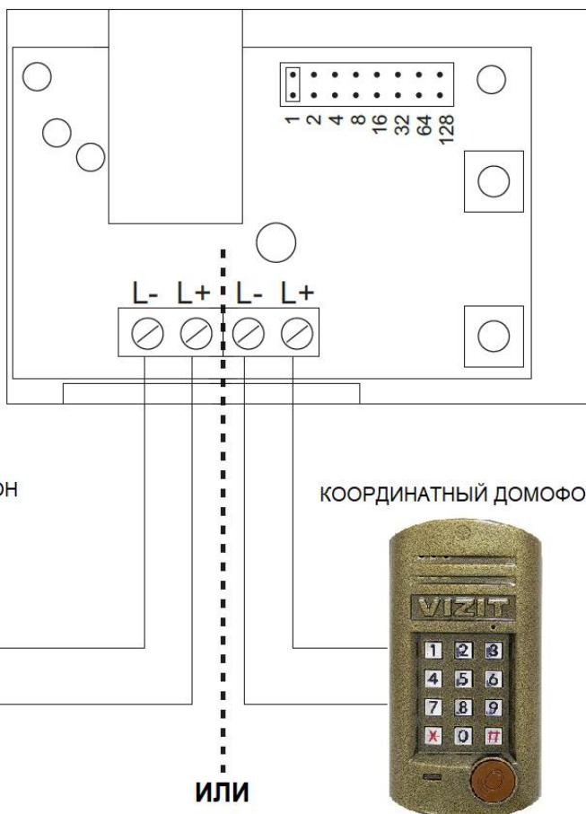
**ВНИМАНИЕ:** одновременное подключение на вход трубы для цифрового и координатного домофона категорически не допускается!!!
