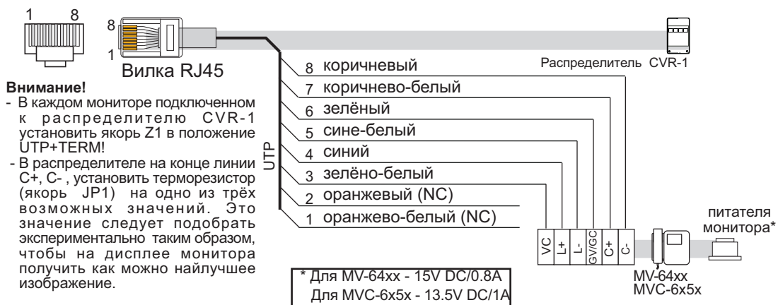
Рис. 39: Видеосистема CD-3100. Подключение монитора - характеристика вилки и розетки RJ-45 для подключения монитора - нет в CVR-1
