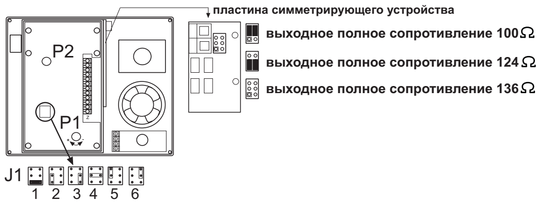
Рис. 9: Наружная панель- установка физического номера и исполнительные регулирующие элементы
