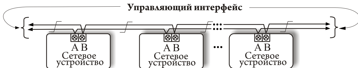
а) Правильное подключение сетевых устройств к информационной магистрали
