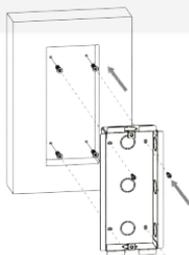
Вставьте четыре пластиковых дюбеля в отверстия. Закрепите монтажную коробку четырьмя винтами ST4x20.
