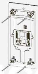
Установите четыре монтажных крепления "А" и "В" на место и закрепите их винтами.
