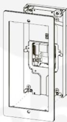
Четыре выступа на декоративной рамке вставляются в углубления на задней части устройства (обрезиненная часть рамки на рисунке повернута к зрителю).
