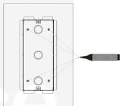
Отметьте четыре отверстия для винтов фиксирующих монтажную коробку
