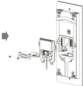
Пропустите кабели через отверстие в задней крышке и подключите к соответствующим разъемам ВП. Возьмите подходящую по размеру кабели резиновую заглушку и установите ее в отверстие задней крышки. Установите скобу для фиксации кабелей и закрепите двумя винтами M2.5x6.
