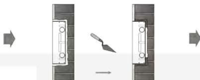
Затем используйте цемент или алебастр, чтобы заполнить зазор между стеной и коробкой.
