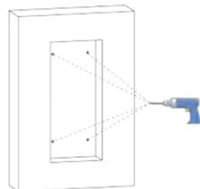
Снимите монтажную коробку. Просверлите отверстия диаметром 5мм и глубиной 25мм.
