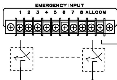
При замыкании клеммы 1-8, и клеммы СОМ включаются соответствующие группы усилителей RA-8236 (см. инструкцию к RA-8236), индикаторы CH1-CH8 (поз.4) загораются красным цветом. Сигнал со входа EM1 поступает на выход блока OUT (поз.16) и на выход усилителя RA-8236 который запрограммирован в соответствующую группу. При этом основной регулятор громкости VOLUME (поз.8) блокируется, регулировка громкости становится возможной только при помощи регулятора EM1 (поз.17).
