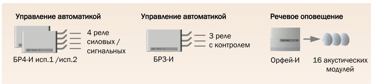
Рисунок 20 Исполнительные устройства S2
