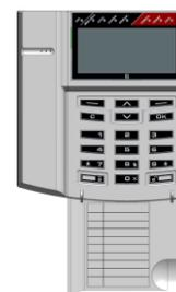
При программировании каждого устройства индикации конфигурируется связь встроенных индикаторов с индицируемыми элементами. Каждый индикатор способен индицировать состояние произвольных зон, групп зон, входов или выходов сегмента.
