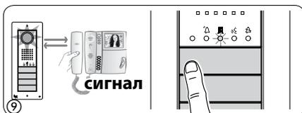
**Программирование угла обзора камеры вызывной панели.** При программировании кнопок вызова настройка угла обзора камеры может быть выполнена в соответствии с описанной выше процедурой.
