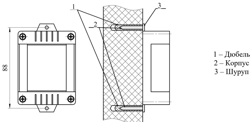
Произвести разметку поверхности под монтажные отверстия корпуса на выбранном месте установки изделия. Просверлить два отверстия диаметром 6 мм., глубиной 30-35 мм.
