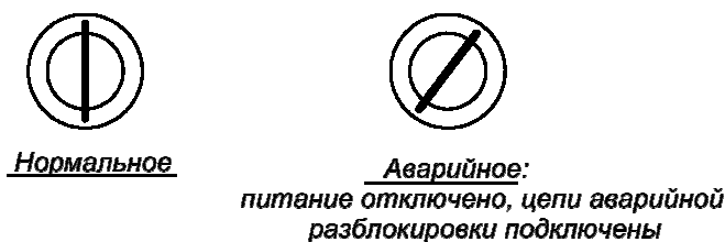
Рис. 2 Положение ключа выбора режима
