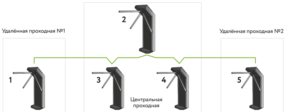
Рисунок 9.10 - Пример размещения оборудования
