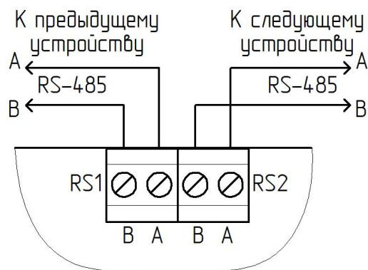
Рисунок 8 – Подключение RS-485
