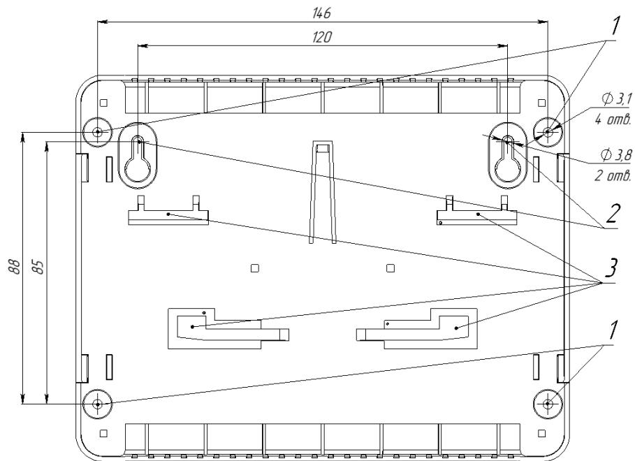
1 – монтажные отверстия для винтов DIN7981 2,9 × 25;
