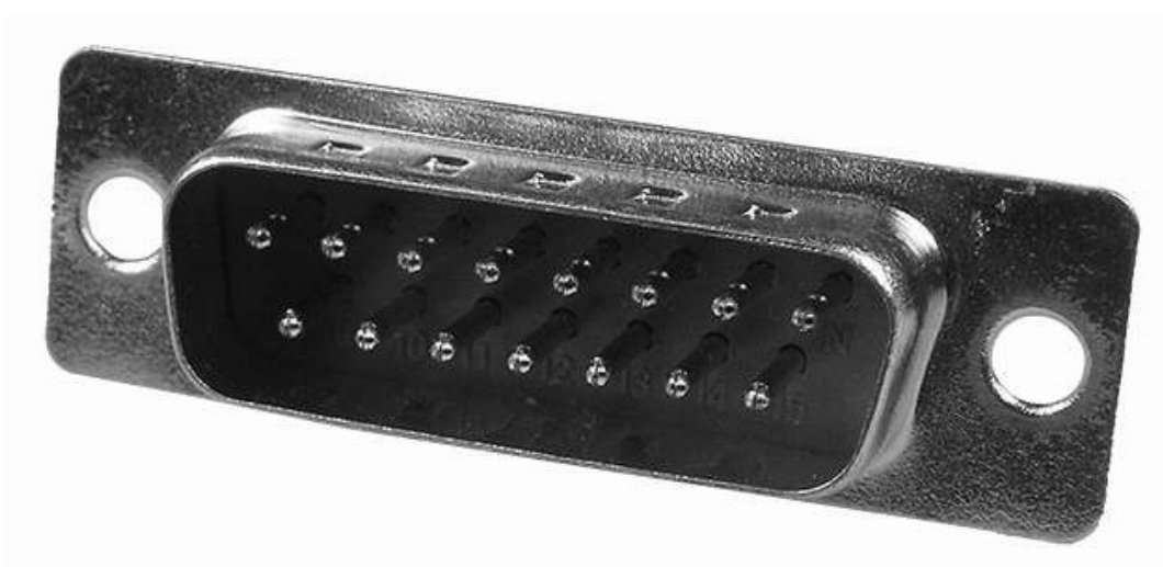
Штекер DB-15M, подключаемый к блоку механики PERCo.
