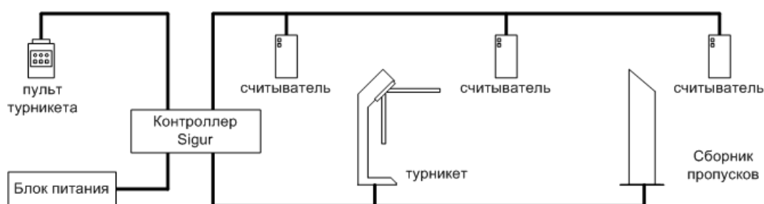
Пример подключения турникета с картоприёмником.
