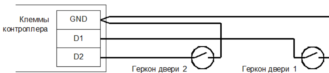
Подключение датчиков открытия дверей.
