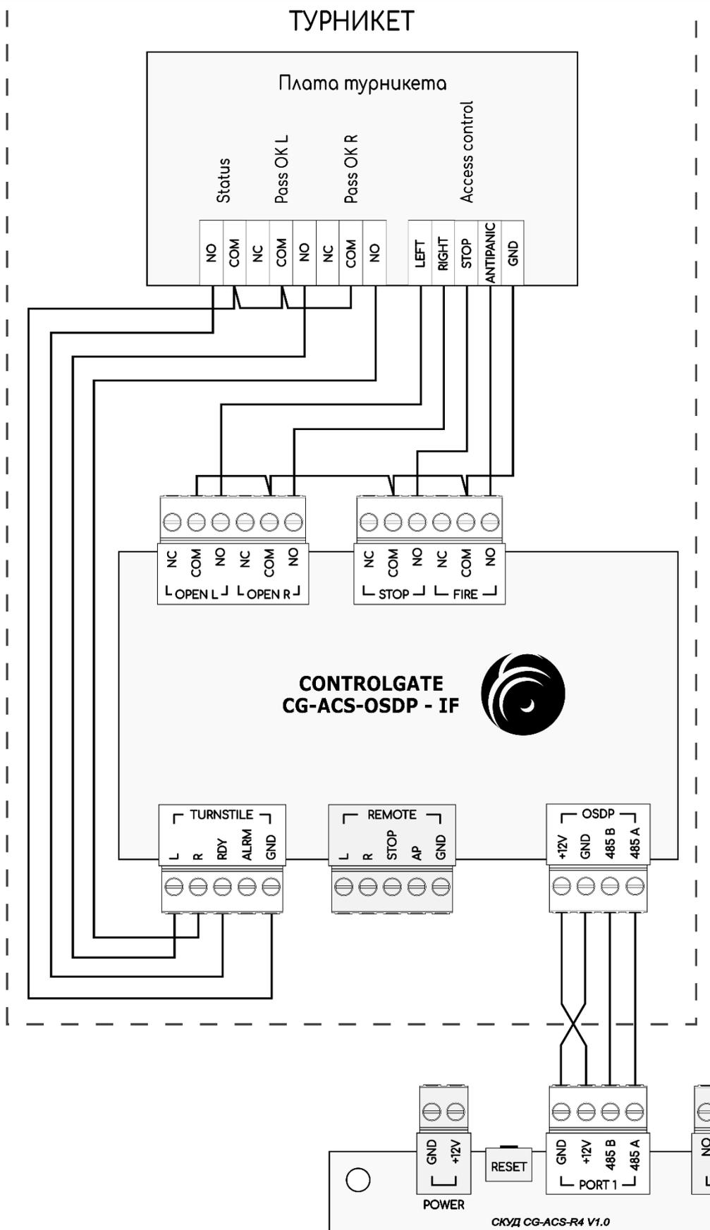
Рисунок 14. Подключение турникета через модуль сопряжения
