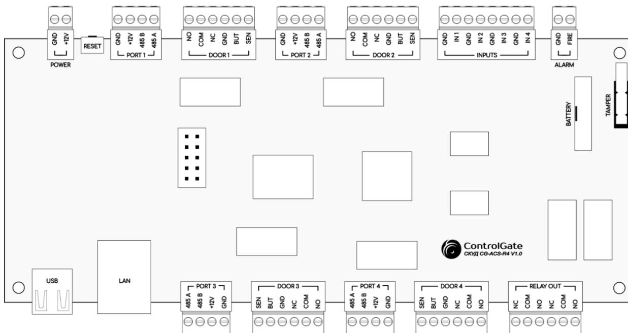
Рисунок 1. Схема расположения элементов и разъемов на плате
