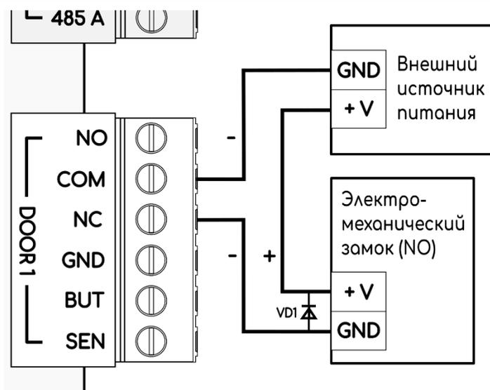
Рисунок 9. Подключение нормально открытого электромеханического замка
