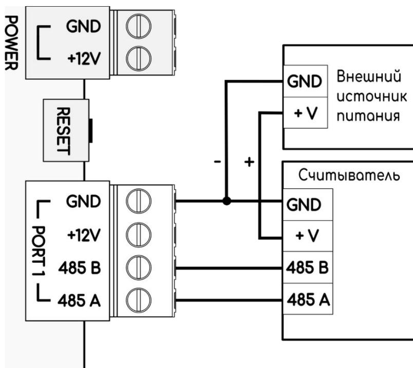
Рисунок 5. Подключение счетчика с внешним источником питания
