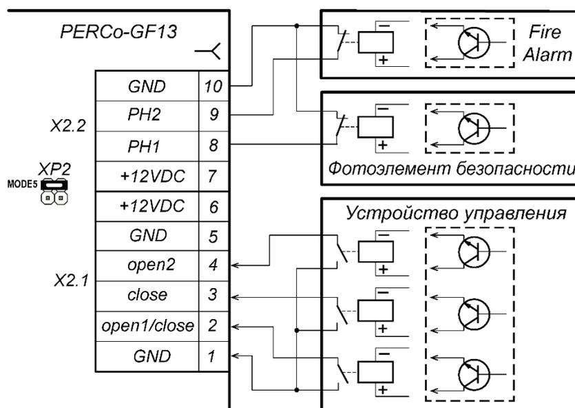
Рисунок 4. Схема подключения управляющих элементов
