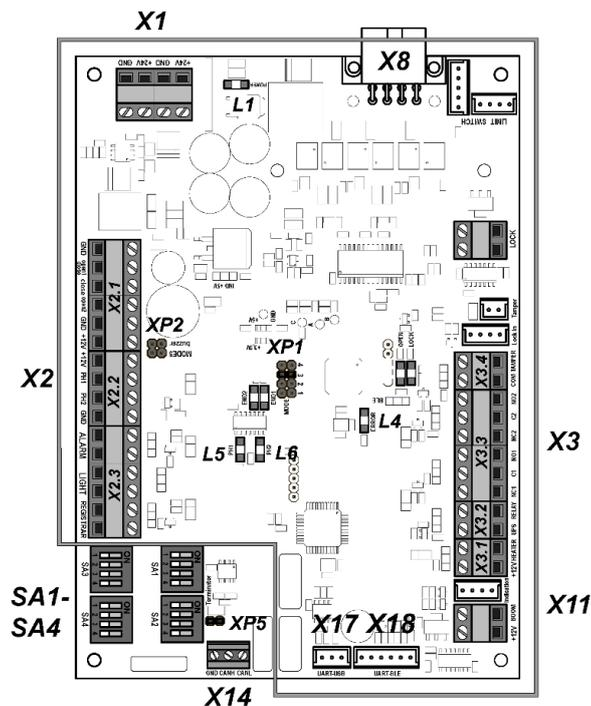
Рисунок 3. Внешний вид платы управления и расположение элементов
