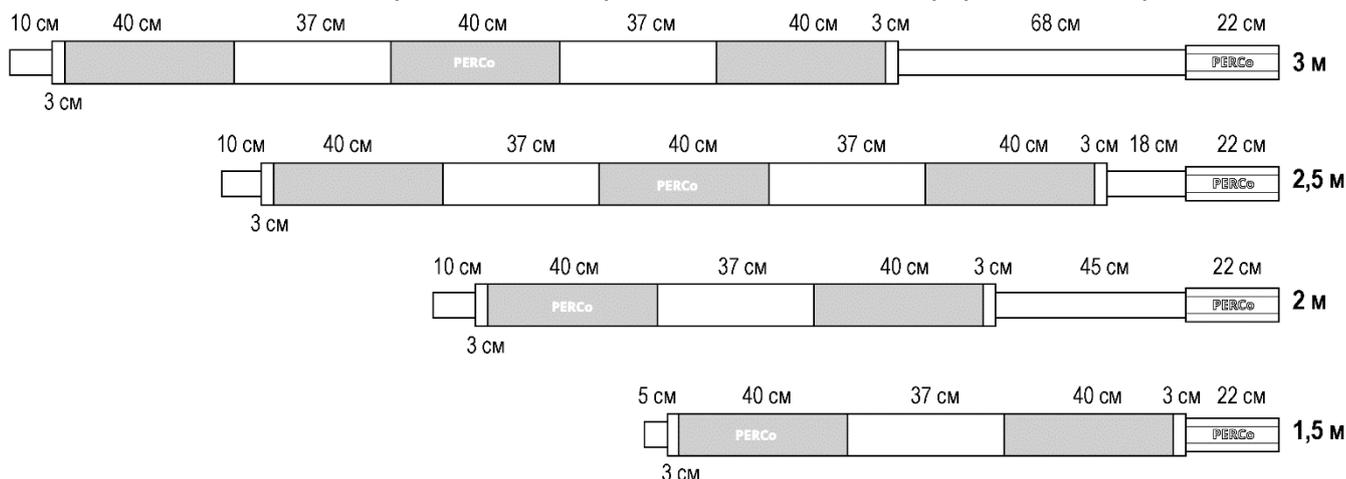
Рисунок 9. Примеры расположения буфера на стрелах разной длины
