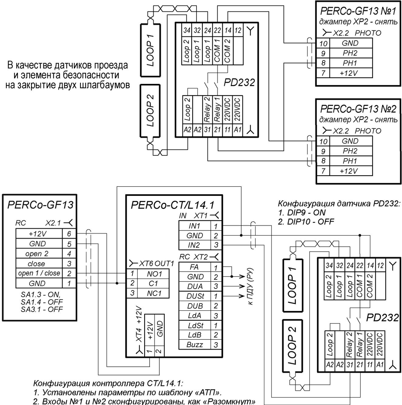
В качестве датчиков направлений проезда через шлагбаум при помощи контроллера СКУД (направление А - от петли №1 к петле №2, направление В - от №2 к №1)
