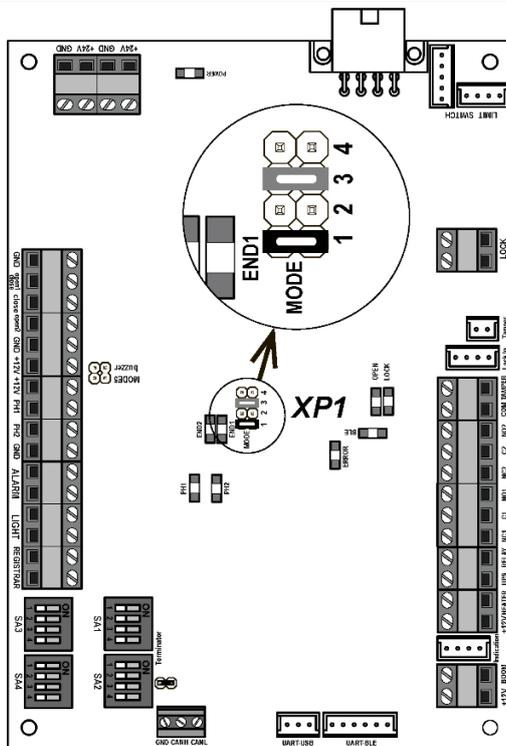
Рисунок 11. Расположение джампера «MODE1» при левостороннем положении стрелы
