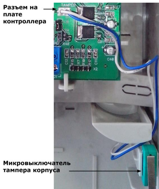
Рисунок 22. Подключение датчика вскрытия корпуса
