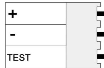
Рисунок 3. Назначение контактов разъема POWER
