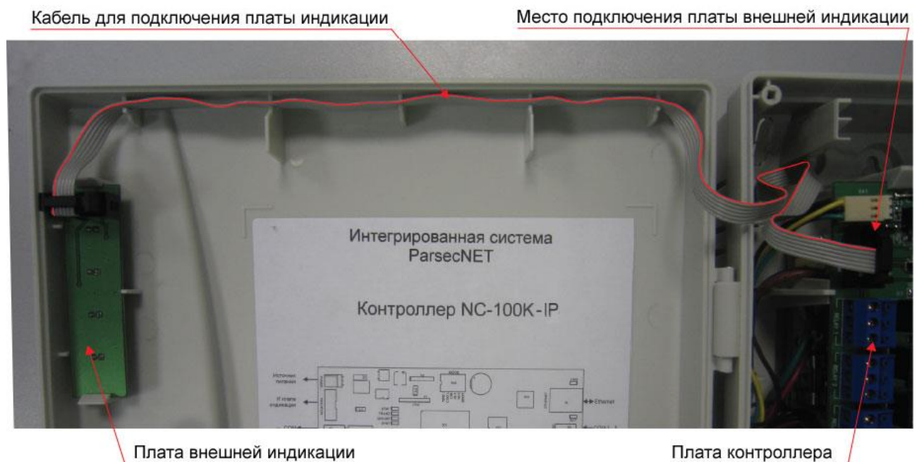
Рисунок 26. Схема подключения платы индикации
