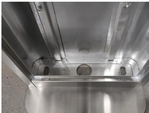
Рисунок 5. Основание турникета с отверстиями
