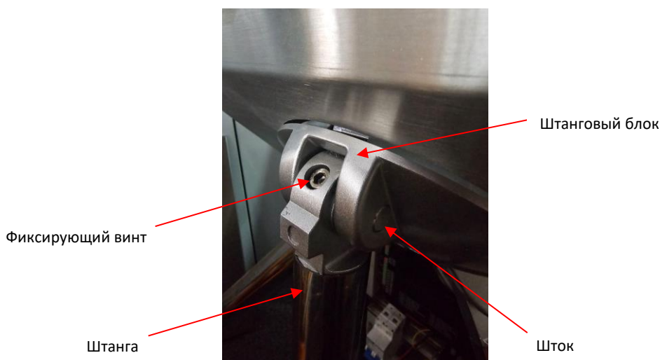
Рисунок 2. Блок штанг турникета
