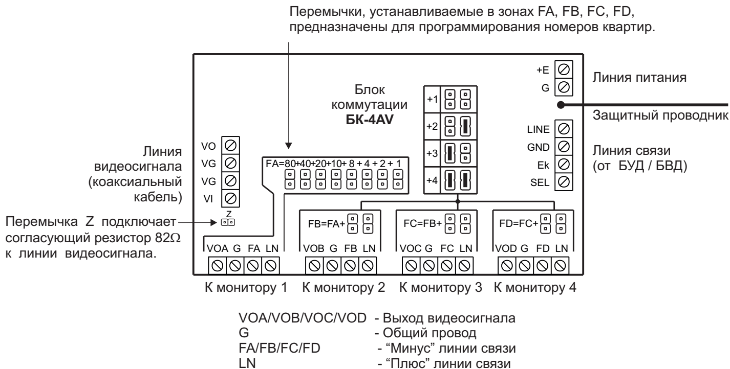
Рисунок 3 - Расположение клемм, назначение цепей и переключателей
