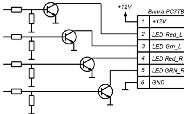
Рисунок 6 Схема управления индикацией
