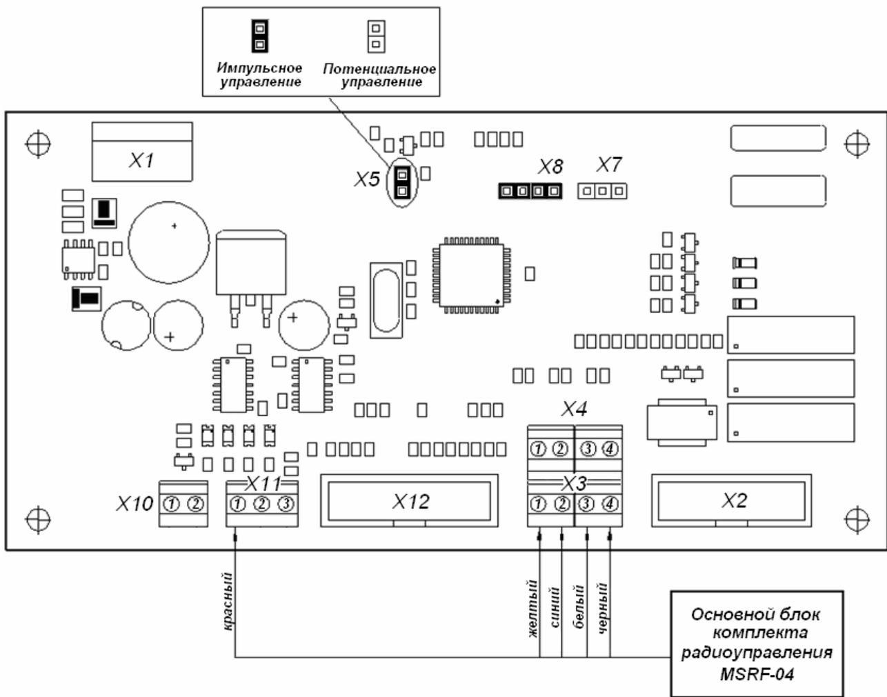
**Рисунок 10** Схема подключения устройства радиуправления MSRF-04 к модулю процессорному
