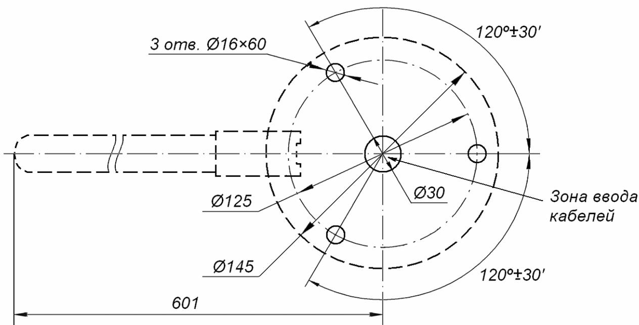
**Рисунок 7 Схема разметки для монтажа турникета (пунктиром показаны габариты стойки турникета и положение одной из его створок)**
