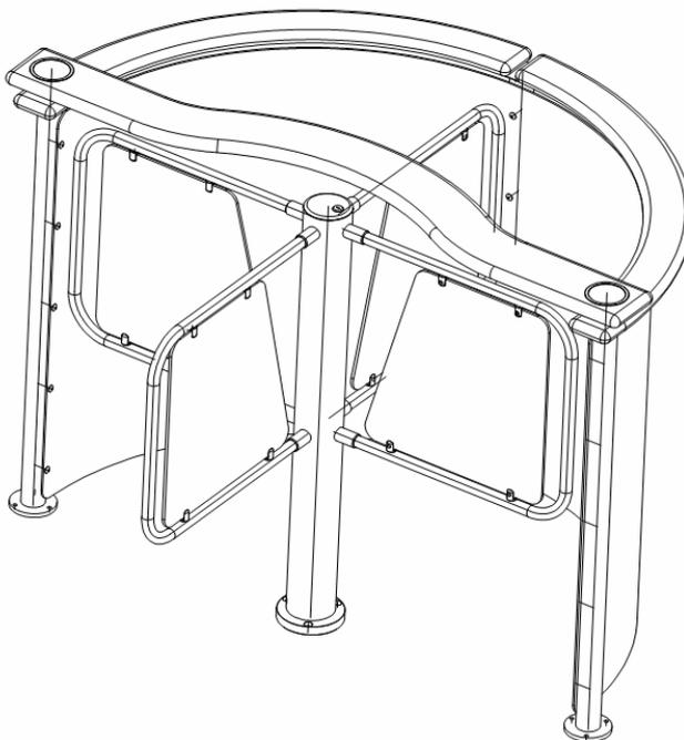
Стойки формирователя прохода – шлифованная нержавеющая труба  $\varnothing 50$  мм; поручни – бук (ясень), массив; заполнение – поликарбонат листовая тонированный; мнемонические блоки индикации.
