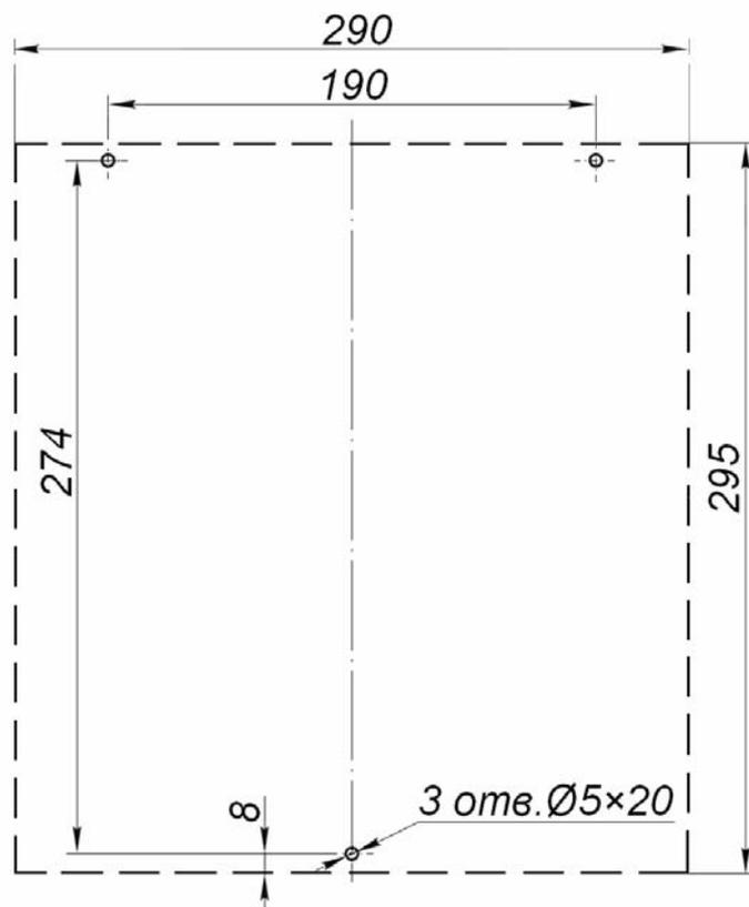
Рисунок 8. Разметка отверстий для установки блока управления.
