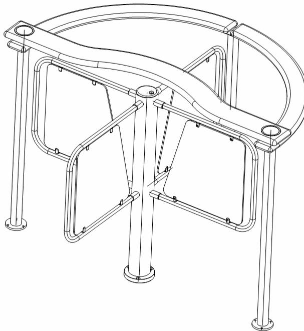
Стойки формирователя прохода – шлифованная нержавеющая труба Ø50 мм, поручни – бук (ясень), массив, мнемонические блоки индикации.
