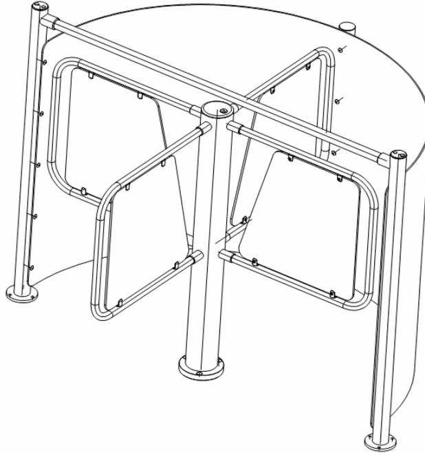
Стойки формирователя прохода – шлифованная нержавеющая труба Ø50 мм, поручень – шлифованная нержавеющая труба Ø32 мм, заполнение – поликарбонат листовой тонированный, символные блоки индикации.
