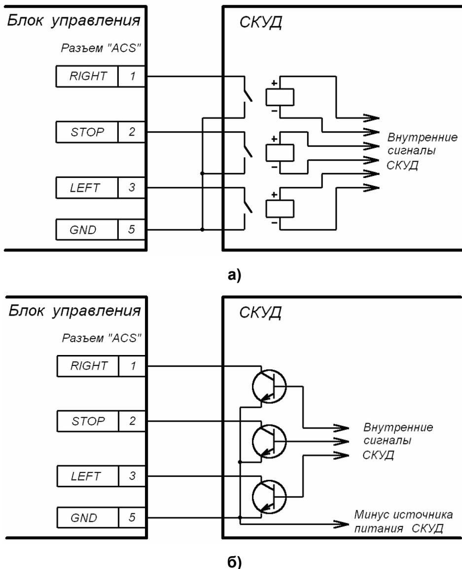
Рисунок 5 Управляющий элемент СКУД нормально разомкнутый контакт реле (а); Управляющий элемент СКУД транзисторная схема с открытым коллекторным выходом (б)
