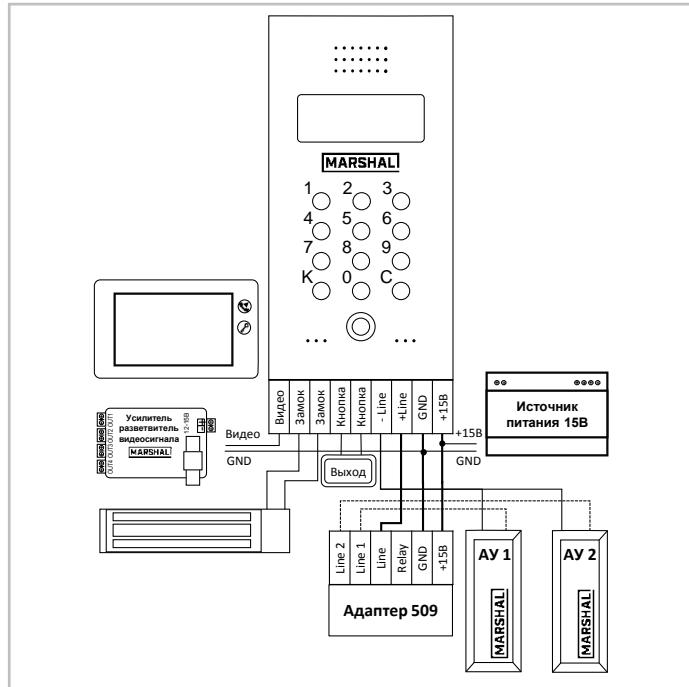
Перед подключением электропитания проверьте все соединения. После подключения электропитания, на индикаторе на 3 секунды появится номер версии домофона, далее на правом индикаторе панели появится точка. Домофон готов к работе.
