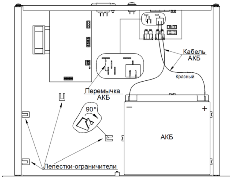
Рисунок 2 – установка и подключение внутренних АКБ
