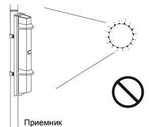
Не допускайте попадания на приемник инфракрасного луча от другого извещателя.
