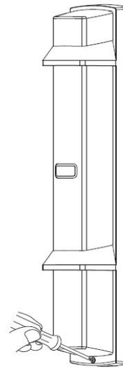
③ Затяните винт блокировки крышки
