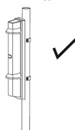
Устанавливайте извещатель на расстоянии не менее 1 м от стены или ограждения, параллельного лучу.
