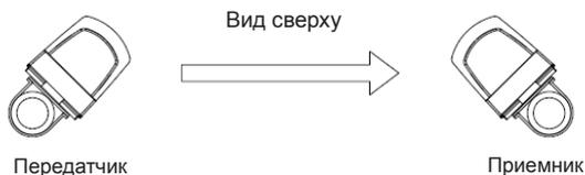
Если установка все же осуществляется данным образом, дальность действия извещателя равна половине номинального значения (в силу ослабления луча при прохождении через угол крышки).
