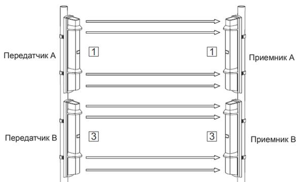
Поскольку приемника В может достигать луч передатчика А, произведите настройку извещателей как указано на рисунке выше (цифра обозначает номер канала).
