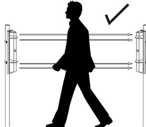
Для монтажа извещателя должен использоваться столб диаметром от 34 до 48 мм.
