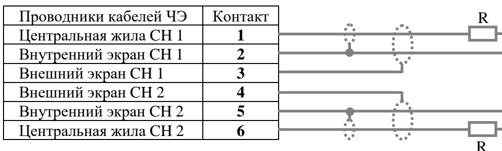
Рис. 8.2. Электрическая схема подключения кабелей чувствительных элементов
