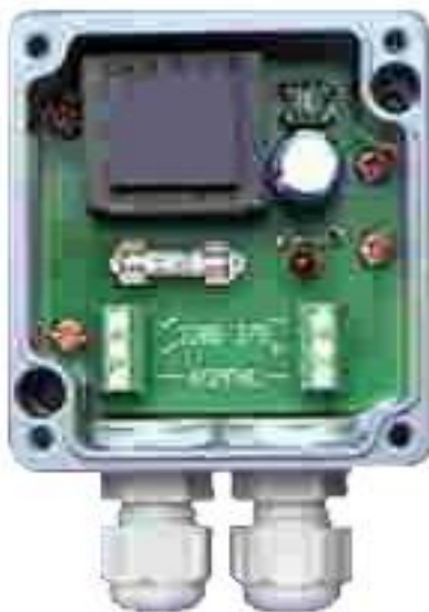
Рис. 8.5. Вид модуля питания со снятой крышкой и схема подключения
